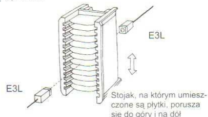
Laserowy czujnik fotoelektryczny E3L-2E4 (szczelina o średnicy 0,1 mm)
